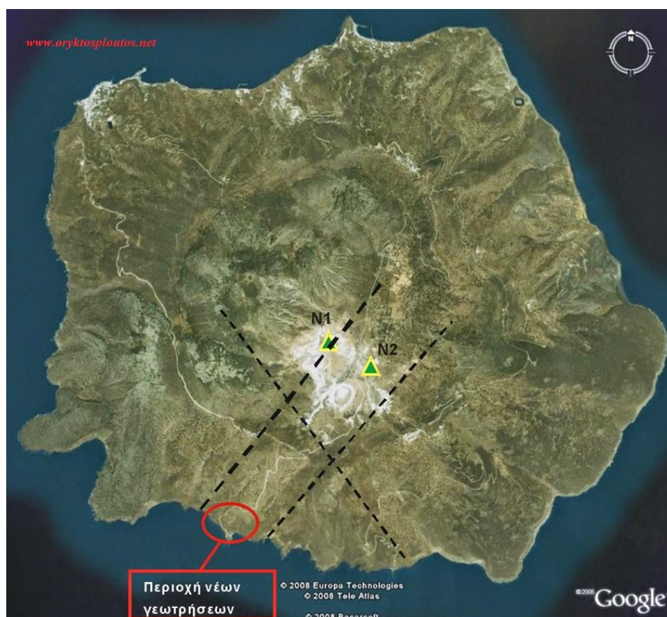
Σχήμα 3.1 Θέσεις γεωθερμικών γεωτρήσεων της ΔΕΗ στη Νίσυρο, όπου σημειώνονται και οι κύριες ρηξιγενείς ζώνες.
