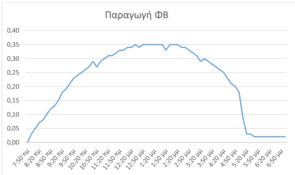
Σχήμα 8.7 - Παραγωγή ενέργειας φωτοβολταϊκών πλαισίων με κλίση 30° και λευκή ψηφίδα στις 8/9/2020
