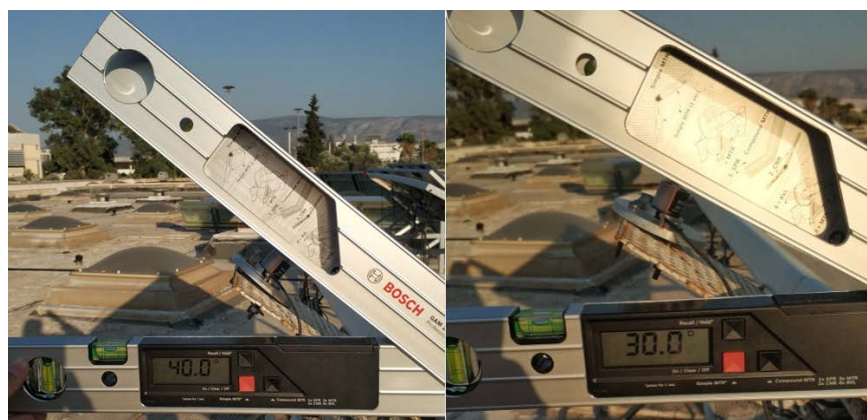
Σχήμα 4.3 - Χρήση κλισιοσκοπίου για την ταύτιση της γωνίας του πυρανομέτρου με εκείνη των φωτοβολταϊκών πλαισίων της πειραματικής διάταξης
