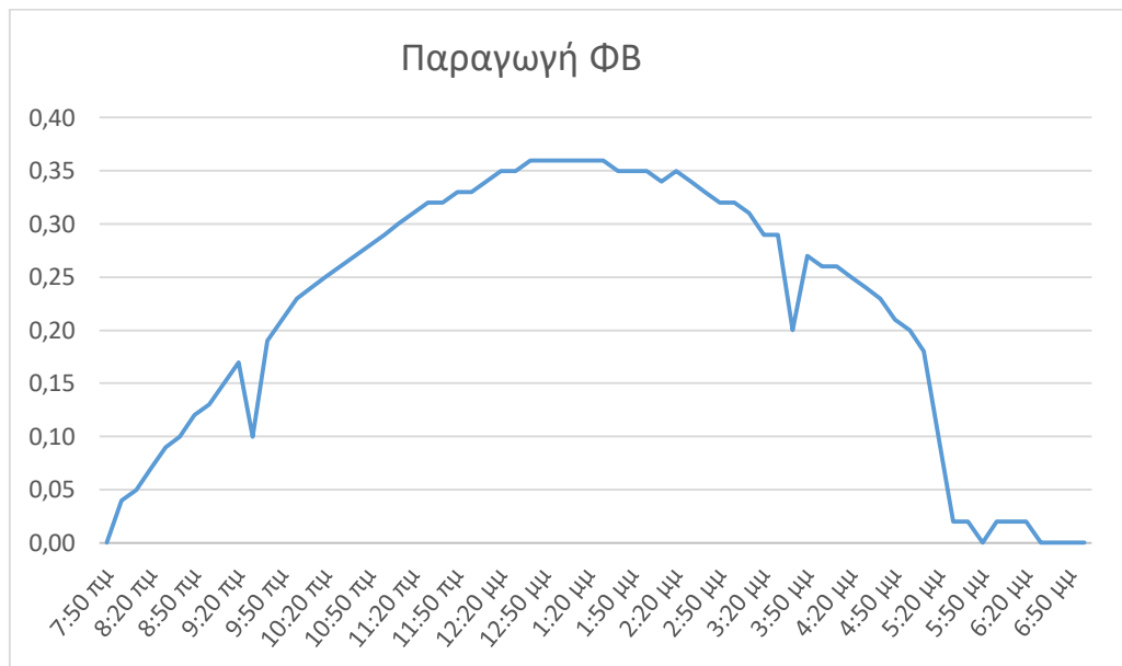
Σχήμα 8.2- Παραγωγή ενέργειας φωτοβολταϊκών πλαισίων με κλίση 30° και λευκή ψηφίδα στις 7/9/2020
