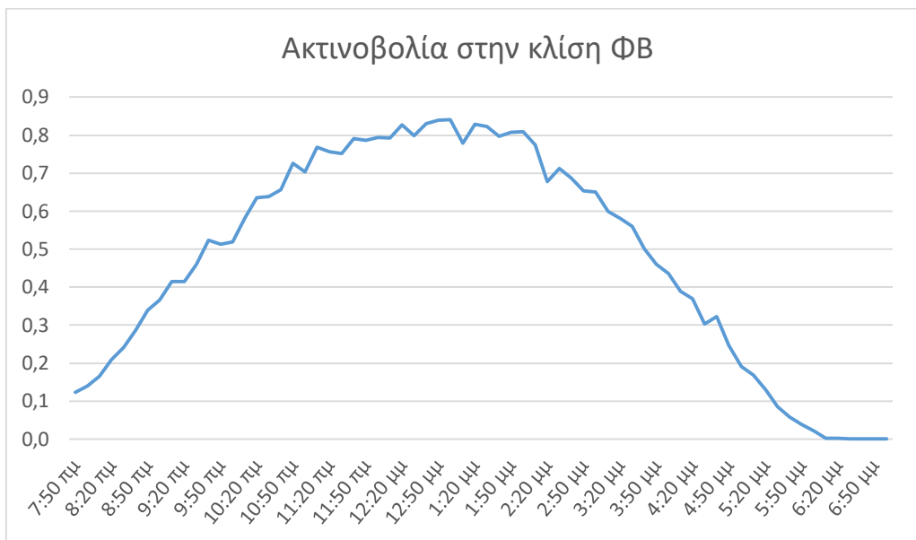
Σχήμα 8.21 - Ηλιακή ακτινοβολία στην κλίση των φωτοβολταϊκών πλαισίων με κλίση 40° στις 14/9/2020
