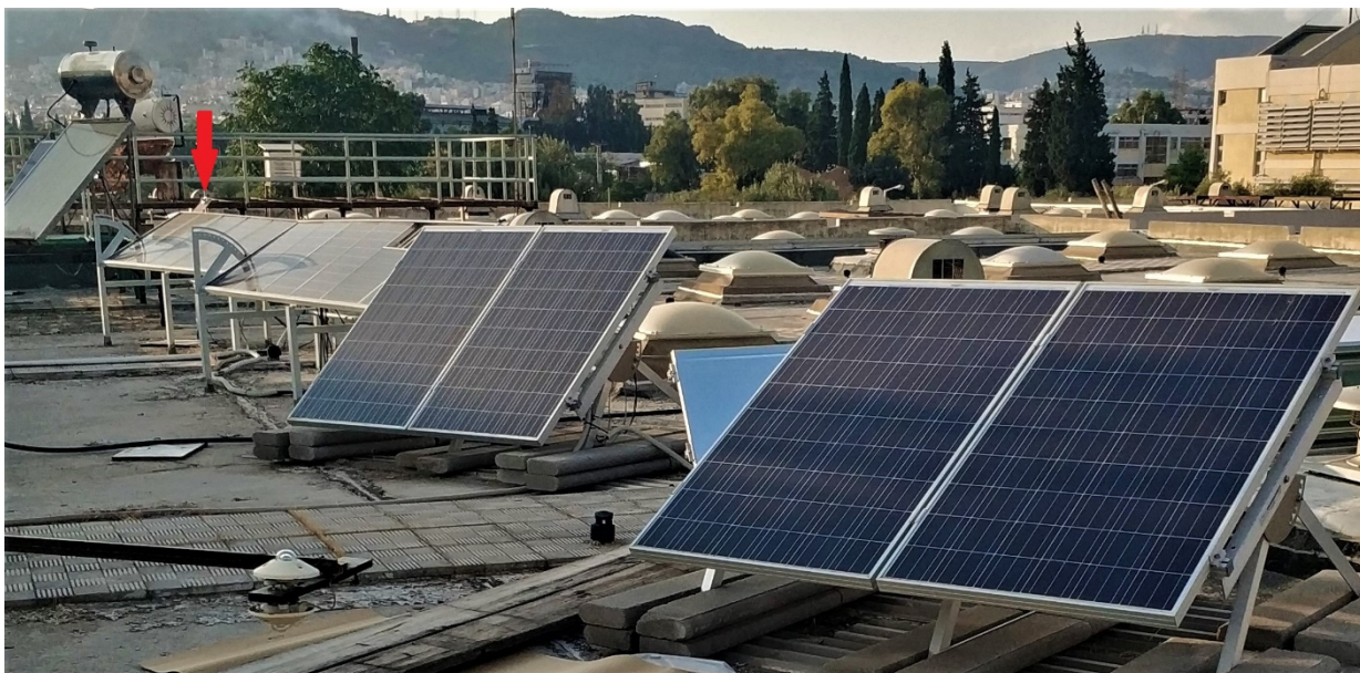
Σχήμα 5.7 - Απεικόνιση πυρανόμετρου LI-COR σε σχέση με το σκιαζόμενα υπόλοιπα όργανα του πειράματος
