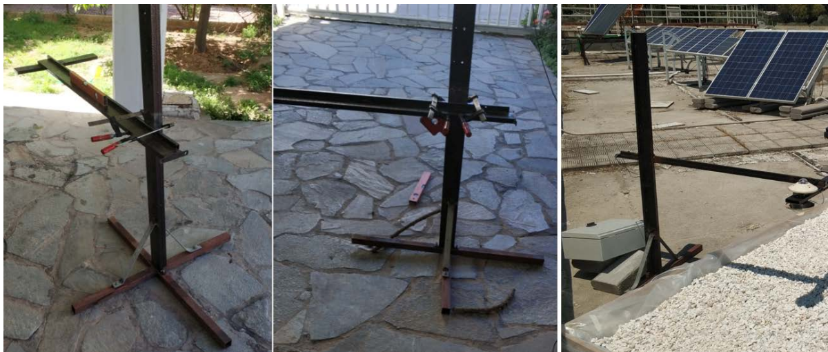
Σχήμα 4.11 - Συγκόλληση βραχίονα στον κορμό της βάσης
