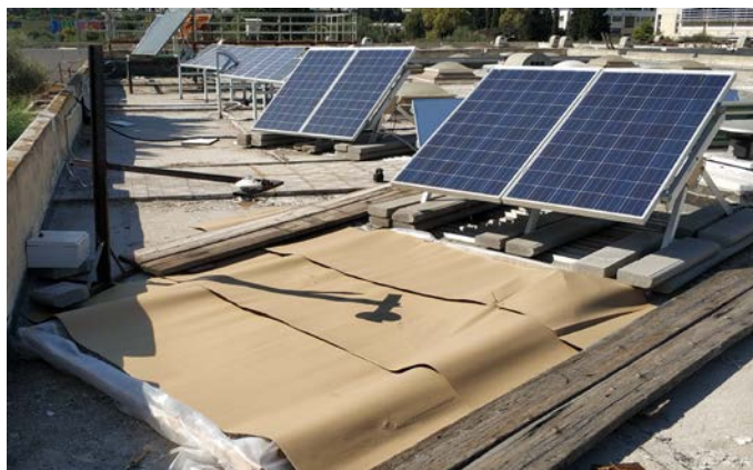
Σχήμα 4.8 - Πειραματική διάταξη με ανακλαστικό υλικό χαρτόνι τύπου «οντουλέ»
