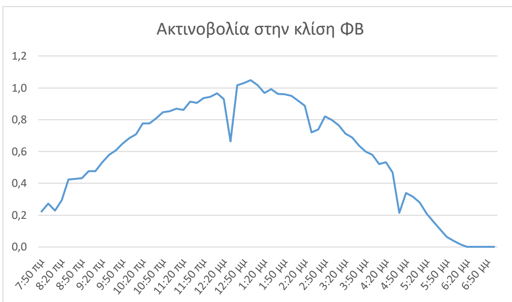
Σχήμα 8.16 - Ηλιακή ακτινοβολία στην κλίση των φωτοβολταϊκών πλαισίων με κλίση 30° στις 13/9/2020
