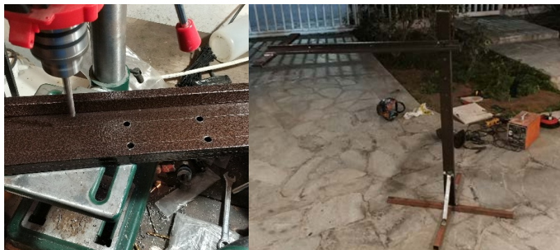
Σχήμα 4.10 - Κατασκευή βραχίονα με δυνατότητα αυξομείωσης ύψους
