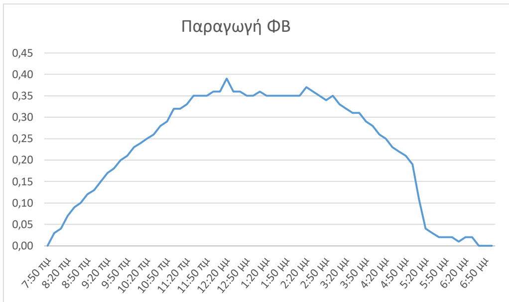
Σχήμα 8.12 - Παραγωγή ενέργειας φωτοβολταϊκών πλαισίων με κλίση 30° και χαρτόνι τύπου «οντουλέ» ως ανακλαστικό υλικό στις 12/9/2020
