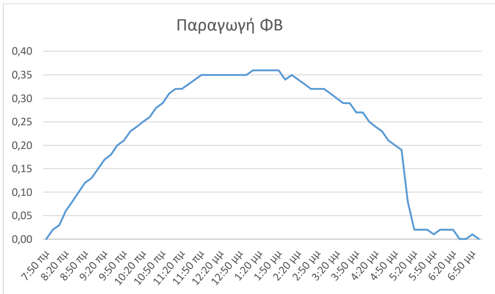
Σχήμα 8.27 - Παραγωγή ενέργειας φωτοβολταϊκών πλαισίων με κλίση 40° και χαρτόνι τύπου «οντουλέ» ως ανακλαστικό υλικό στις 15/9/2020
