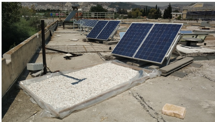
Σχήμα 4.6 - Τελική διάταξη με πλαίσιο και λευκή ψηφίδα ως ανακλαστικό υλικό
