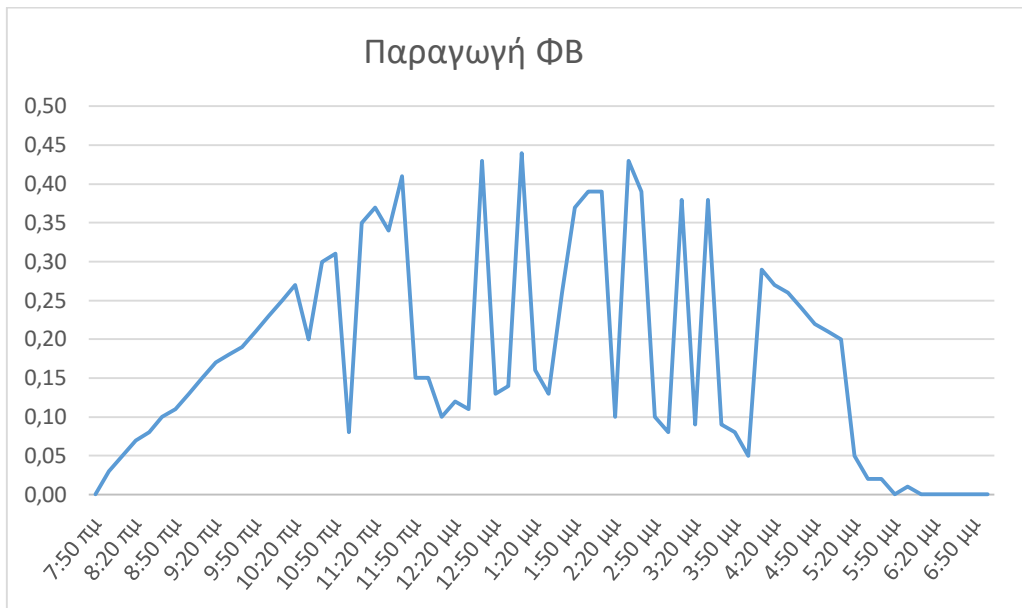
Σχήμα 5.9 - Παραγωγή ενέργειας φωτοβολταϊκών πλαισίων με κλίση 40° και λευκή ψηφίδα στις 5/9/2020
