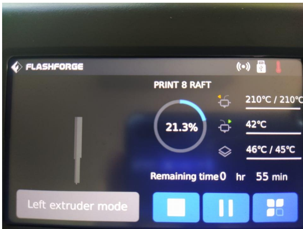
Εικόνα 2.41: Οι ενδείξεις και τα χαρακτηριστικά εκτύπωσης μέσω της οθόνης του FlashForge Creator 3
