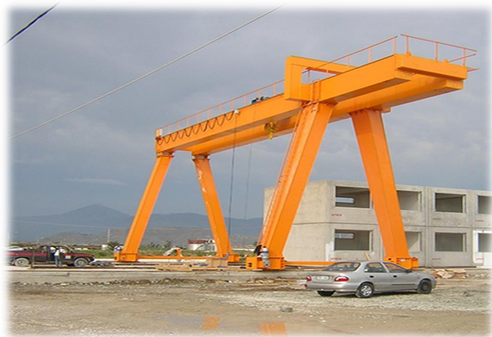
Εικόνα 9: Γερανός πυλώνας διπλού φορέα (Architas.gr, 2019)
