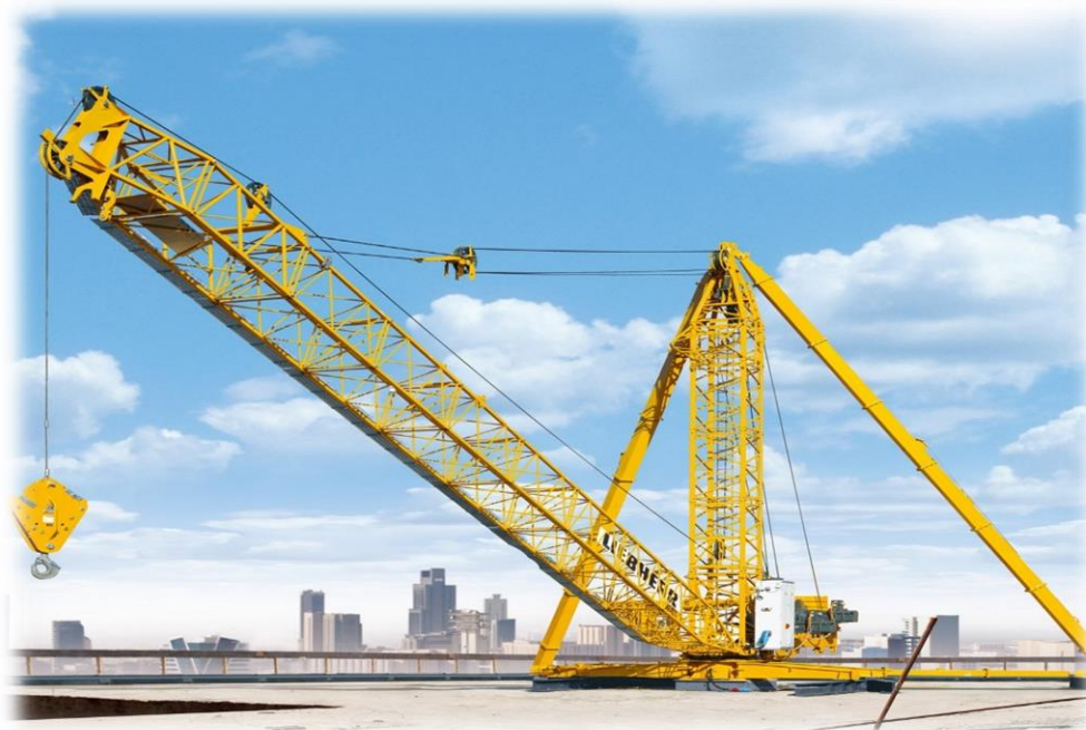
Εικόνα 13: Σταθερός γερανός τύπου «Derrick» (liebherr.com, 2019)
