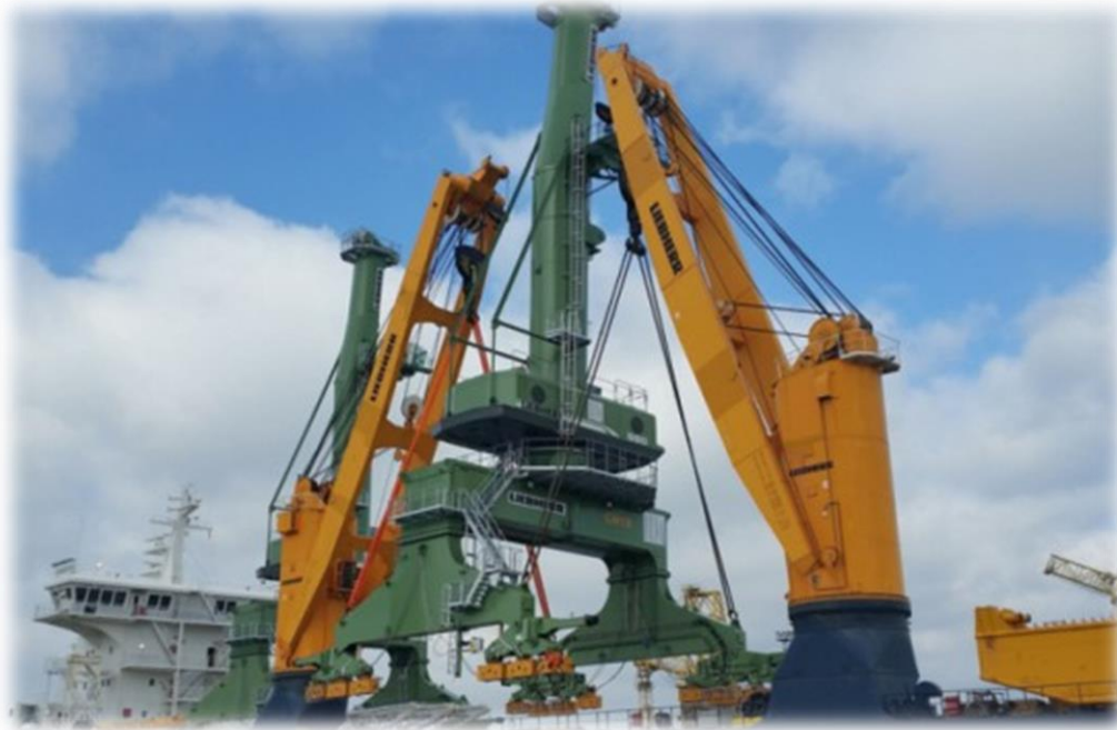
Εικόνα 18: Γερανός πλοίου (liebherr.com, 2019)
