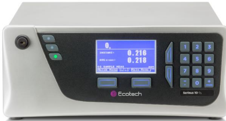
Εικόνα 4.2: Εξωτερική μορφή του αναλυτή (Πηγή: https://www.ecotech.com )
