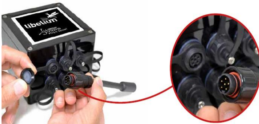
Εικόνα 4.13: Σύνδεση αισθητήρων με κύριο σώμα συσκευής (Πηγή: LIBELIUM, 2020)
