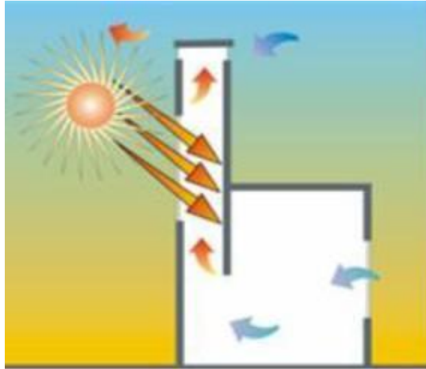
Εικόνα 15. Λειτουργία ηλιακής καμινάδας.
