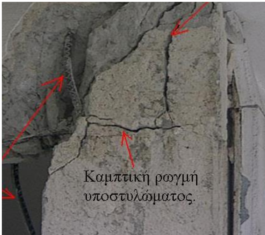
Σχήμα 2. 3: Καμπτική αστοχία υποστυλώματος (Πηγή: http://ecourses.dbnet.ntua.gr/9421.html )
