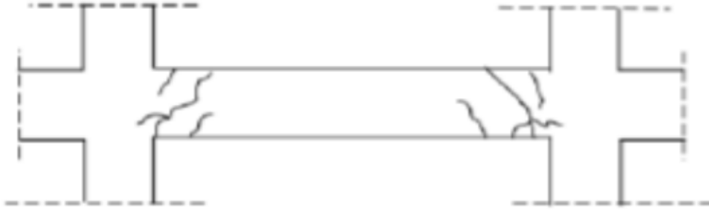
Σχήμα 2. 11: Διαμητική αστοχία δοκού 11
