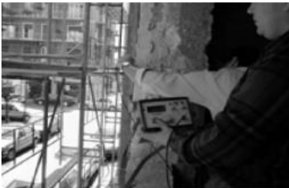
Σχήμα 5. 2: Υπέρηχος σε σκυροδέμα (Πηγή: Σπυράκος, 2004)
