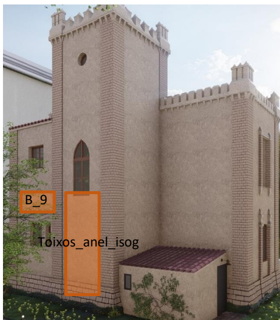
Σχήμα 5.28 Πρώτες αστοχίες στοιχείων σε διάτμηση, της πρώτης καταγραφής - πίσω όψη
