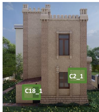
Σχήμα 5.12. Αστοχία των στοιχείων σε ροπή κάμψης – όψη Δ
