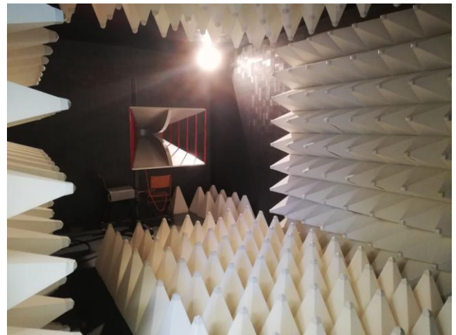
Εικόνα 24: Εσωτερικό και εξωτερικό ανηχοϊκού θαλάμου
