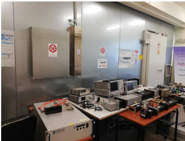
Εικόνα 24: Εσωτερικό και εξωτερικό ανηχοϊκού θαλάμου
