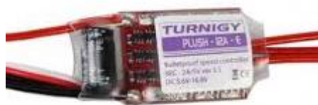
Εικόνα 11: Τροφοδοτικό ελεγκτή ταχύτητας Turnigy PLUSH-12A[25]
