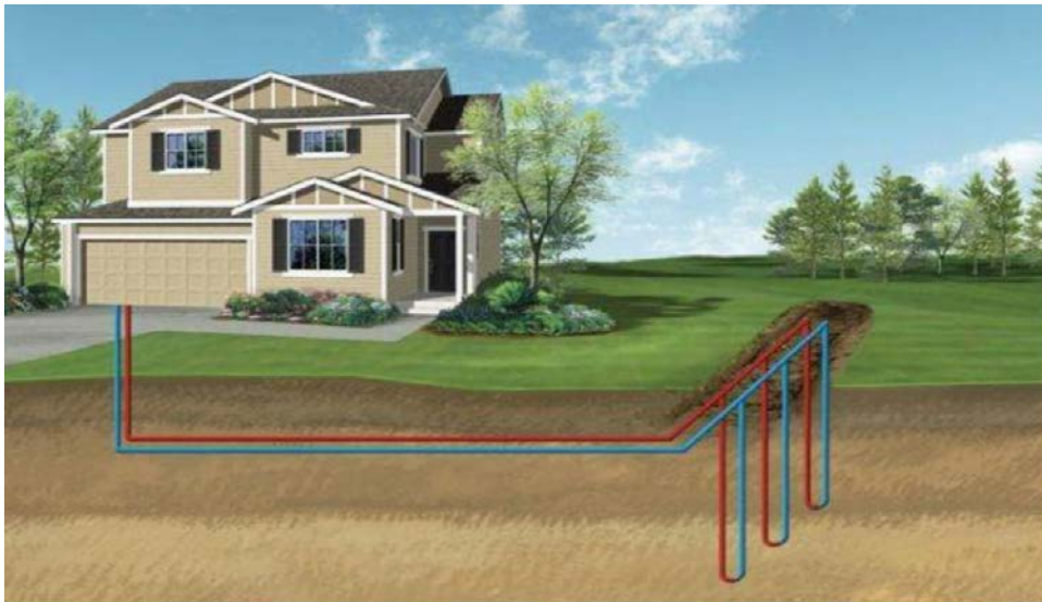
Εικόνα 4.12-4 Γεωθερμική Αντλία Θερμότητας
