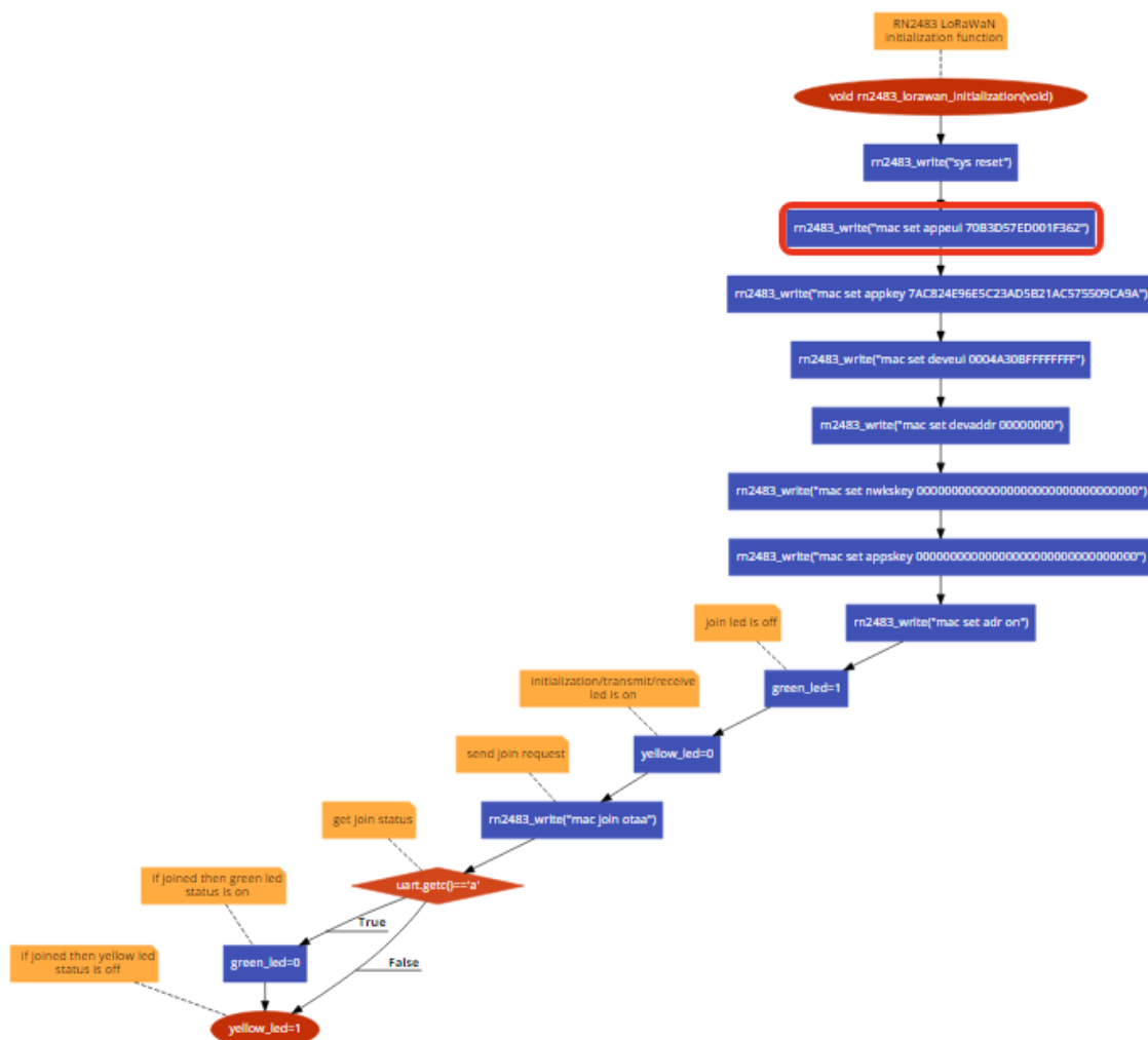
Εικόνα 49: Διάγραμμα ροής της συναρτήσεως αρχικοποιήσεως των παραμέτρων LoRaWAN και συνδέσεως της τελικής συσκευής
