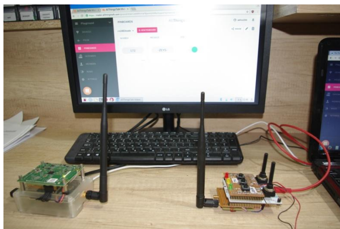
Εικόνα 54: Η πειραματική διάταξη με την πύλη δικτύου και την τελική συσκευή
