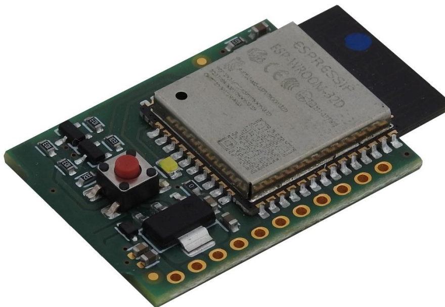
Εικόνα 57 Η πλακέτα του μικροελεγκτή μετά την κόλληση των ηλ.εξαρτημάτων
