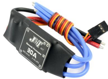
Εικόνα 13: Ελεγκτής Ταχύτητας ESC
