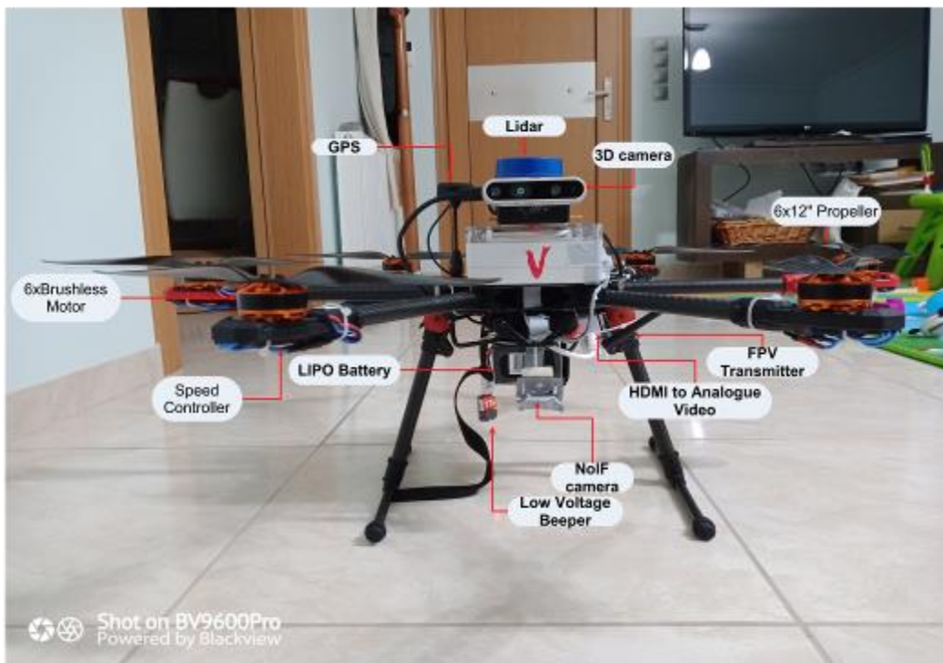
Εικόνα 22: Γενική περιγραφή των συστημάτων του drone
