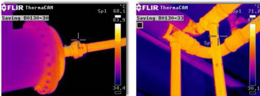
Εικόνα 3.3 Θερμογραφήματα δικτύων, από ενεργειακή επιθεώρηση του ΚΑΠΕ. Πηγή: ΚΑΠΕ
