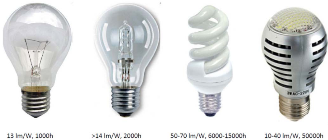
Εικόνα 6.1 Εξέλιξη λαμπτήρων στη διάρκεια του χρόνου
