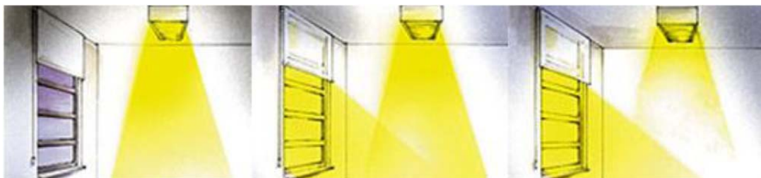
Εικόνα 6.1 Μείωση του τεχνητού φωτισμού, με αξιοποίηση του φυσικού. Πηγή: ΚΑΠΕ
