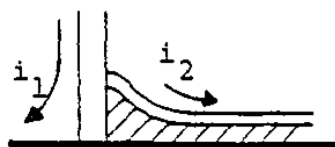
Σχήμα 2.5.5.2-4 : Το καλώδιο τοποθετείται στη μικρότερη δυνατή απόσταση από το έδαφος ώστε να ελαχιστοποιείται ο κλειστός βρόχος μεταξύ του γειωμένου μανδύα και της γείωσης του εργαστηρίου
