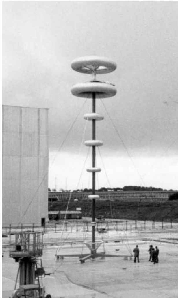
Σχήμα 5.1.5.1-4 : Αποσβεσμένος χωρητικός καταμεριστής σειράς για κρουστική τάση 6MV
