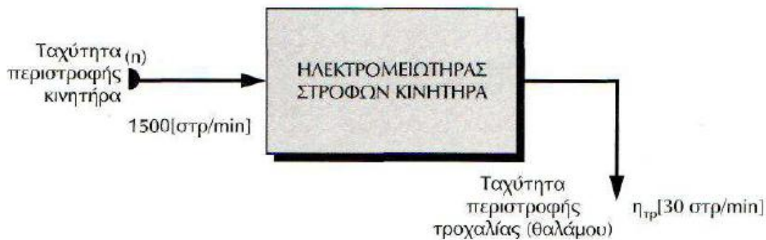
Σχήμα 1 Σχηματική διάταξη λειτουργίας μειωτήρα στροφών
