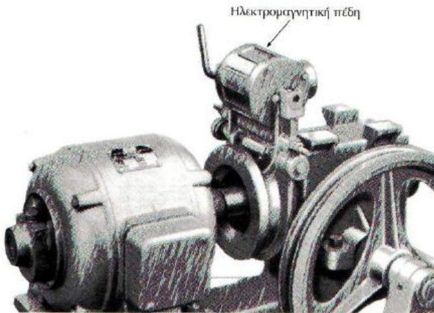
Σχήμα 3 Μορφή ηλεκτρομαγνητικής πέδης ανυψωτικού μηχανισμού ανελκυστήρα.
