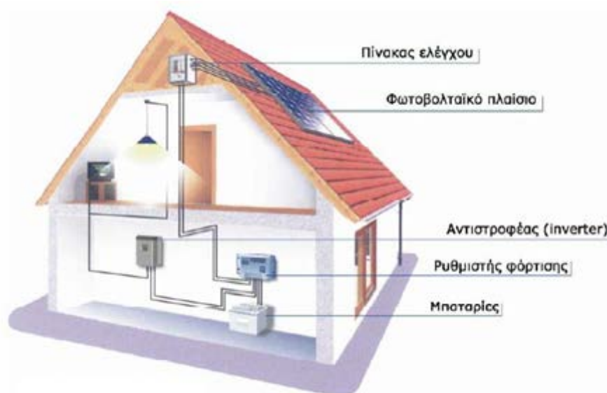
Σχήμα 30: Αυτόνομο φωτοβολταϊκό σύστημα [13]
