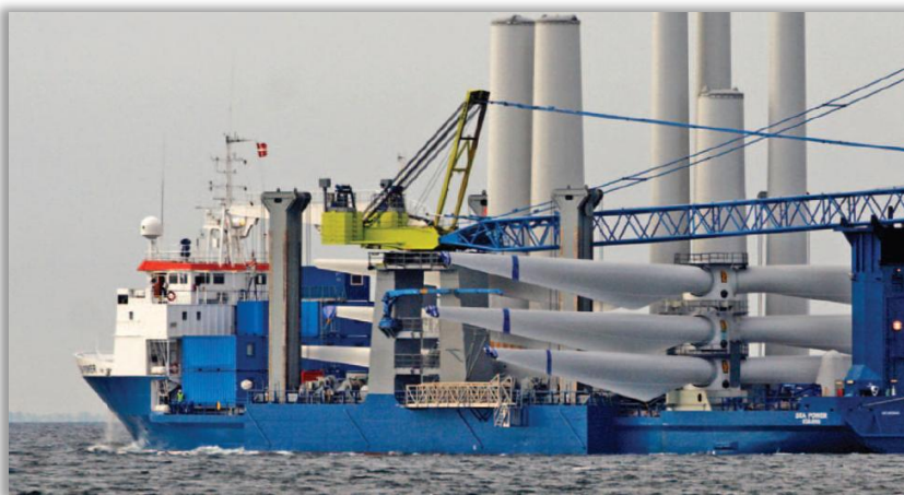
Σχήμα 10.30 Μεταφορά τμημάτων ανεμογεννητριών με ειδικά διαμορφωμένα πλοία.
