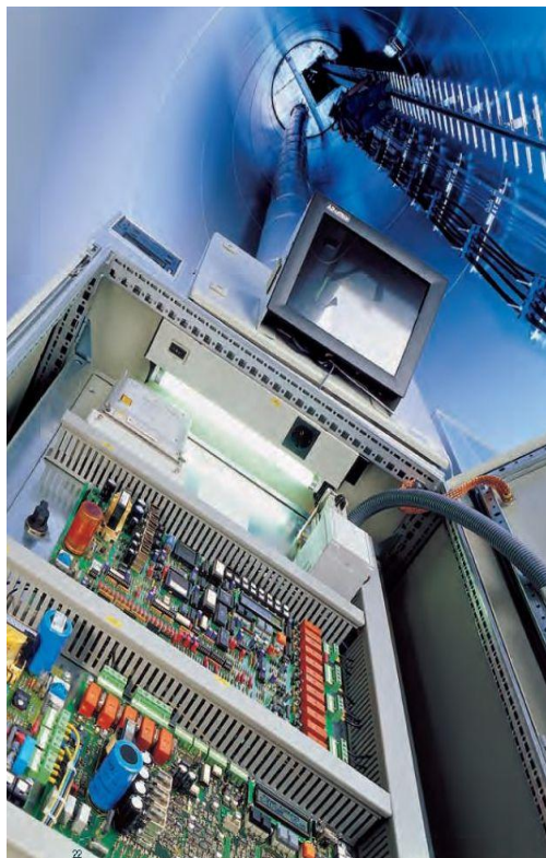
Σχήμα 10.24 Πίνακες ελέγχου ανεμογεννητριών τοποθετημένοι στη βάση (αριστερά) και στην άτρακτο (δεξιά).
