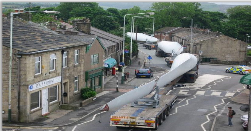
Σχήμα 10.28 Μεταφορά τμημάτων ανεμογεννήτριας.
