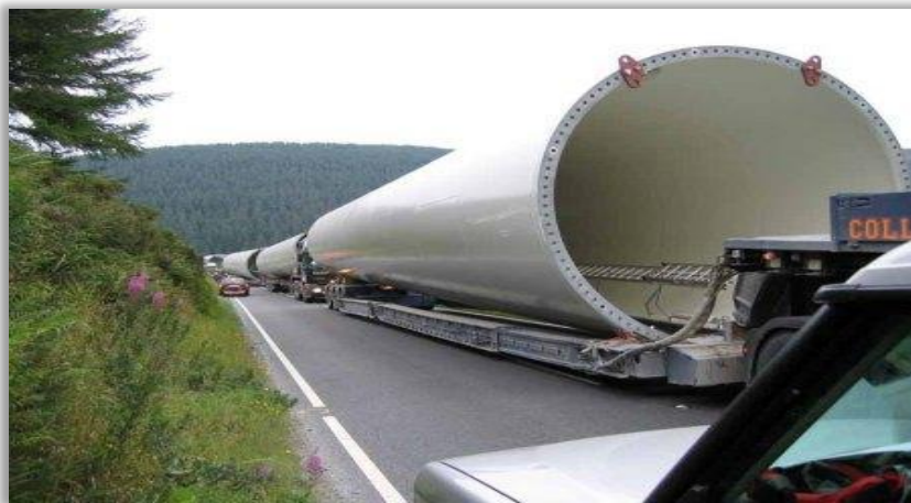
Σχήμα 10.29 Μεταφορά πύργου ανεμογεννήτριας με ειδικά διαμορφωμένα φορτηγά.
