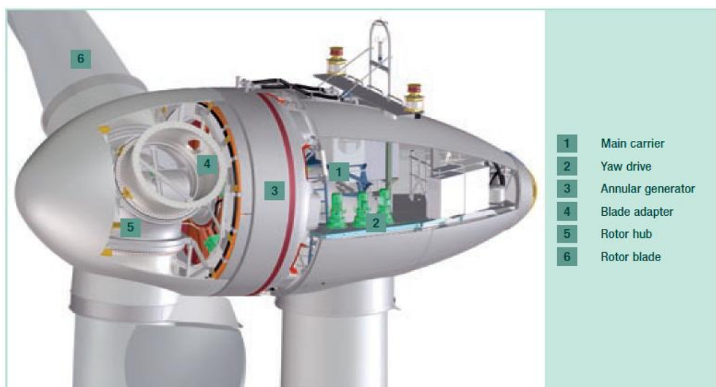
Σχήμα 12.7 Ανεμογεννήτρια Enercon E –82 E3, 3MW.
