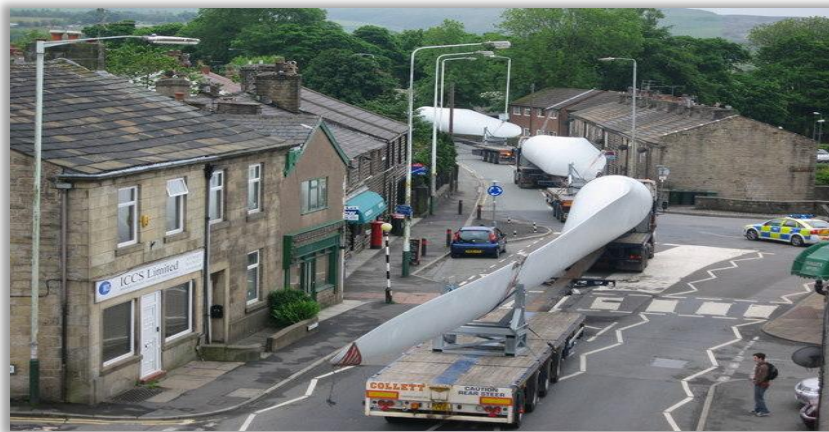
Σχήμα 10.28 Μεταφορά τμημάτων ανεμογεννήτριας.
