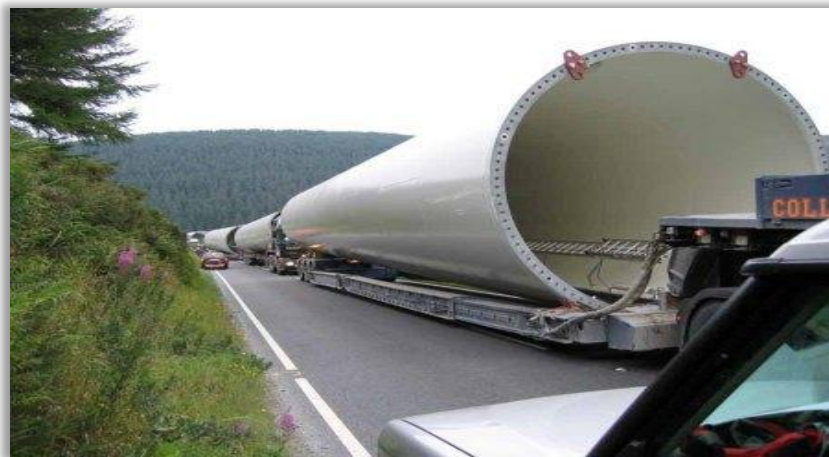
Σχήμα 10.29 Μεταφορά πύργου ανεμογεννήτριας με ειδικά διαμορφωμένα φορτηγά.
