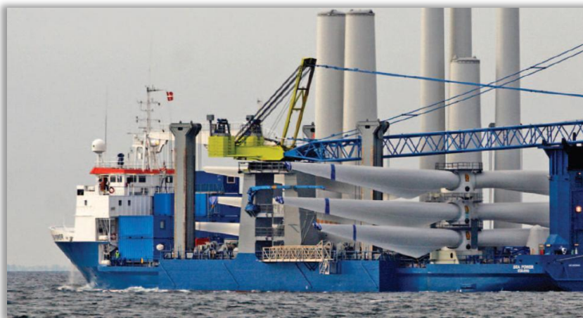
Σχήμα 10.30 Μεταφορά τμημάτων ανεμογεννητριών με ειδικά διαμορφωμένα πλοία.
