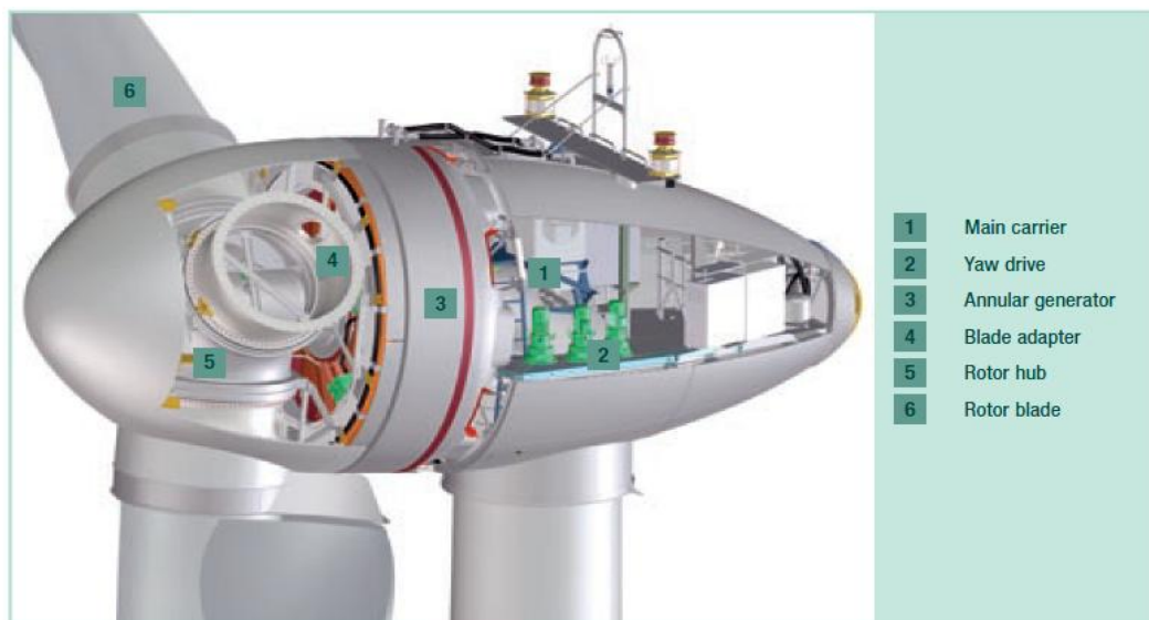
Σχήμα 12.7 Ανεμογεννήτρια Enercon E –82 E3, 3MW.
