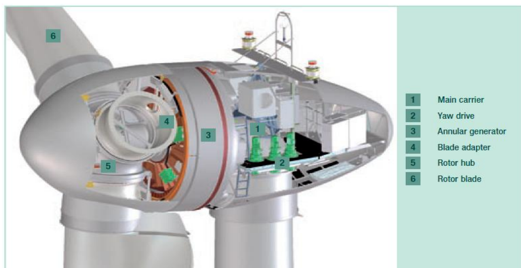
Σχήμα 12.8 Ανεμογεννήτρια Enercon E –82 E2 2,3MW.
