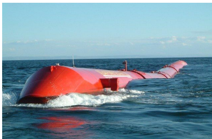
Σχήμα 1.3 Το Pelamis σε λειτουργία. Το πρωτότυπο είναι τοποθετημένο στο European Marine Energy Center, στο Orkney της Σκωτίας.
