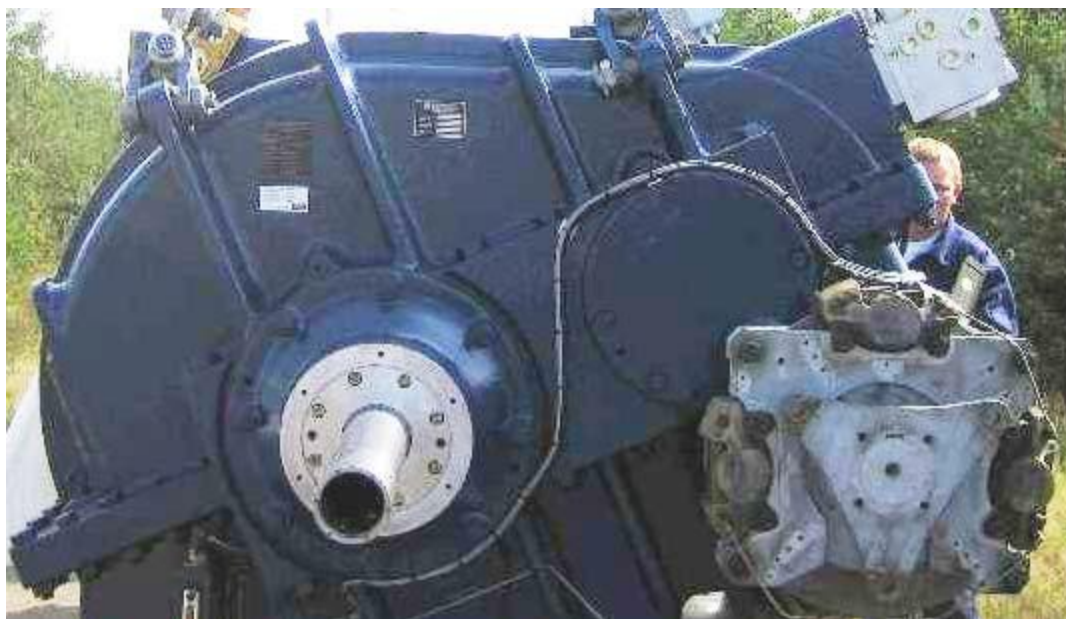
Σχήμα 10.15 Φωτογραφία του κιβωτίου ταχυτήτων του κύριου άξονα και του συστήματος φρένων.
