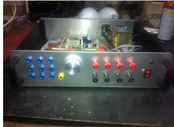
Φωτο 4: Δημιουργία εξόδων & σημείων ελέγχου πλακέτας
