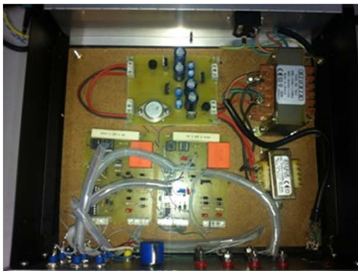
Φωτο 10: Αλλαγή παλιού ποτενσιόμετρου & τοποθέτηση καινούργιου γραμμικού πολύστροφου 10κΩ
