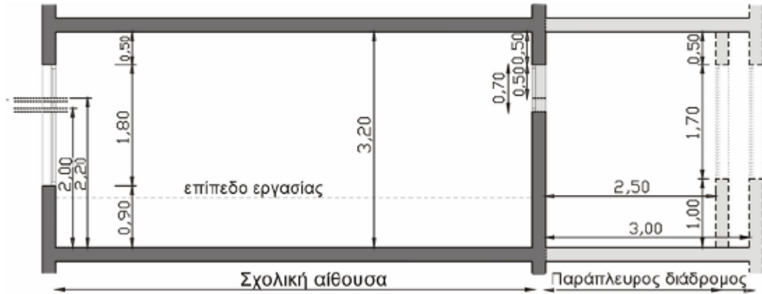
Σχήμα 5.2 Η τομή της σχολικής αίθουσας που προσομοιώθηκε στο RADIANCE. (Πηγή: [7])
