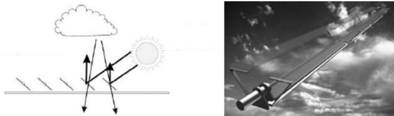
Σχήμα 3.22 Οι ολογραφικοί υαλοπίνακες μπορούν να χρησιμοποιηθούν και ως «επιλεκτικά» σκίαστρα τα οποία αποκόπτουν την άμεση ηλιακή ακτινοβολία, ενώ είναι διαπερατά στη διάχυτη. (Πηγή: [45])
