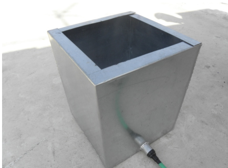
Σχήμα 4.2 Δεξαμενή διαστάσεων (37cm*37cm*50cm)
