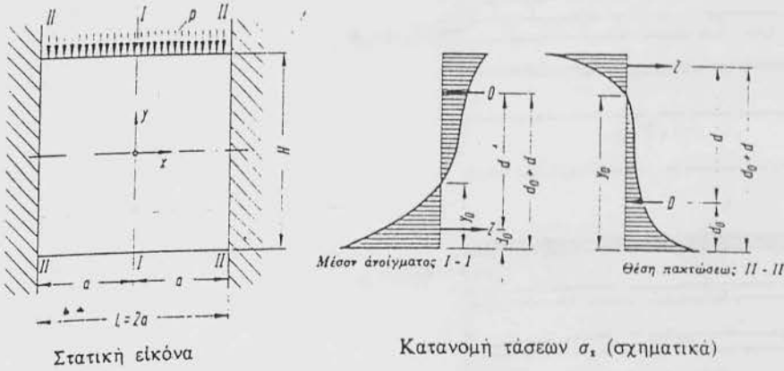
Πίναξ XIII — Περίπτωση φορτίσεως XIII: Άμφιπακτος δίσκος με ομοιόμορφο φορτίο p στο άνω σύνορο
