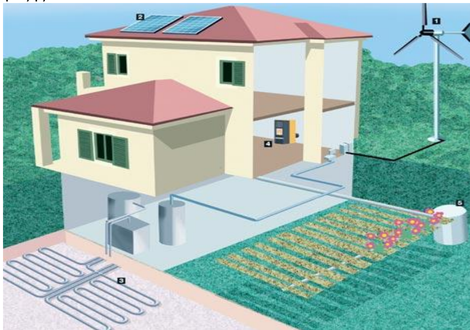
Σχ. 13. Κατοικία με σύστημα γεωθερμικού κλιματισμού.
