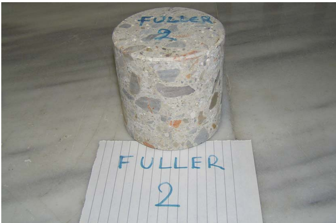
Εικ. 10 Δοκίμιο “Fuller” 1 που διαμορφώθηκε από το κυβικό δοκίμιο “Fuller” 1 για εκτέλεση δοκιμής διαπερατότητας σε νερό.
