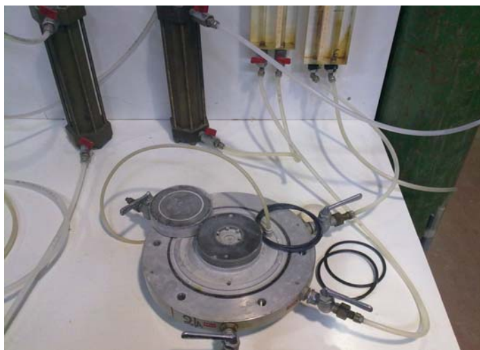
Εικ. 7: Βάση της κυψέλης τριαξονικής συσκευής συνδεδεμένη στη διάταξη πιέσεων και μετρήσεων
